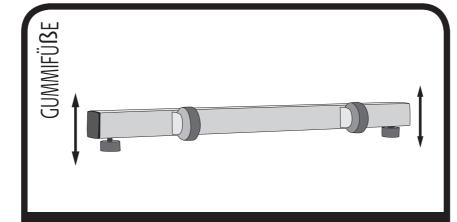
Die Gummifüße sollten stets so angepasst sein, dass das Bike waagrecht steht. Jedes zweite Jahr sollten die Füße ausgetauscht werden, da das Gummi aushärtet und nicht mehr in der Lage ist den Aufprall zu dämpfen.
