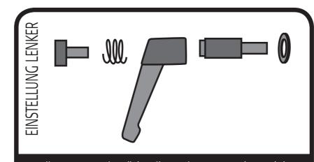
Alle 3 Monate benötigt die Lenkerstange eine Reinigung und Einfettung. Zerlegen Sie hierfür den Lenker vollständig. Reinigen Sie alle Teile gründlich mit einer Drahtbürste. Schmieren Sie die inneren Teile mit Fett ein. Fetten Sie die Hauptschraube vor dem Einbaudes Bikes ein.
