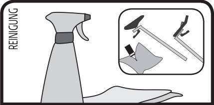
Wischen Sie das Bike nach jedem Training mit einem Microfasertuch ab. Jede zweite Woche sollten die Stützen (Lenker) gereinigt werden, um sie vor Schweiß etc. zu schützen. Ziehen Sie die Sattelstütze und Lenkstange heraus um sie mit einem Vaseline Öl-getränktem Tuch zu reinigen.
