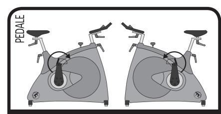
Ziehen Sie alle 2 Wochen die Pedale fest, um zu vermeiden dass diese zu locker werden oder sogar abbrechen. Die Pedale sollten immer in Richtung des Lenkers angeschraubt werden. Nehmen Sie hierzu einen 15 mm Schraubenschlüssel. Pedale sollten nach 1 Jahr oder nach 1500 Stunden ausgewechselt werden.
