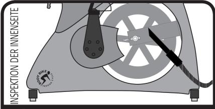
Überprüfen Sie die Kevlar Bremsbeläge nach dem ersten Monat und hiernach alle 3 Monate. Die Kevlar Bremsbeläge sollten ausgetauscht werden, bevor die schwarzen Gummis abgenutzt sind und in Erscheinung treten. Es wäre sinnvoll das Bike bei jeder Inspektion von innen aus zu saugen.
