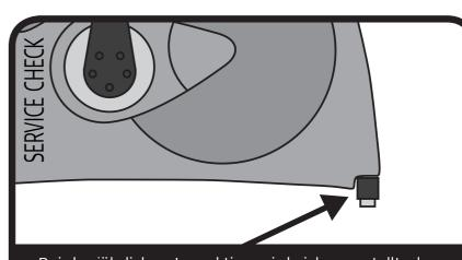
Bei der jährlichen Inspektion wird sicher gestellt, dass das kleine Loch am vorderen Rahmen nicht verstopft ist, um mögliches Wasser oder Schweiß abfließen zu lassen. Überprüfen Sie auch, ob die Lamellen auf dem Poly-v-Riemen und der Riemenscheibe (Antriebsscheibe) sauber sind.
